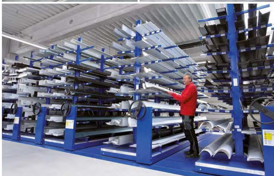
META MULTIBLOC verfahrbare Kragarmregale: die oberen beiden Reihen zeigen die Variante Schwer mit elektromotorischem Antrieb, die untere Reihe zeigt die Variante Leicht mit handbetätigtem Antrieb. Telefonische Beratung 0761 508100
