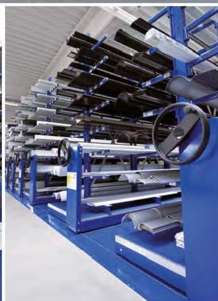
META MULTIBLOC verfahrbare Kragarmregale: die oberen beiden Reihen zeigen die Variante Schwer mit elektromotorischem Antrieb, die untere Reihe zeigt die Variante Leicht mit handbetätigtem Antrieb. Telefonische Beratung 0761 508100
