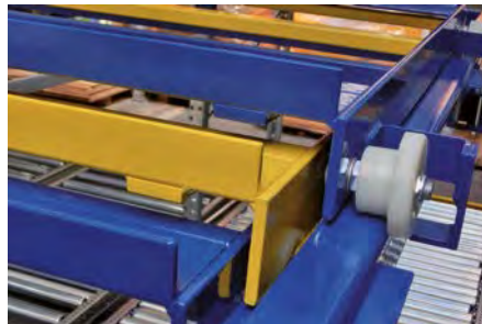
Pushfix Systeme – Wagen anstelle von Rollenbahnen im Einschubregal
