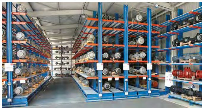
Verschieberegalanlage Steigerung der Lagerkapazität um 110% = 21 Regalzeilen
